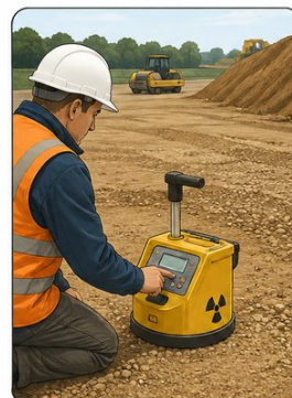
Mesure de la masse volumique au gammadensimètre
